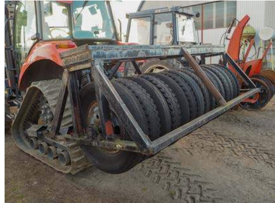
雪踏み用トラクター。後部のタイヤで圧雪して土壌凍結を促し、野良イモ（前年度の収穫時に残ったイモが越冬して、翌春に芽生えたもの）を防除する
