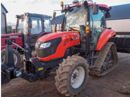
雪踏み用トラクター。後部のタイヤで圧雪して土壌凍結を促し、野良イモ（前年度の収穫時に残ったイモが越冬して、翌春に芽生えたもの）を防除する
